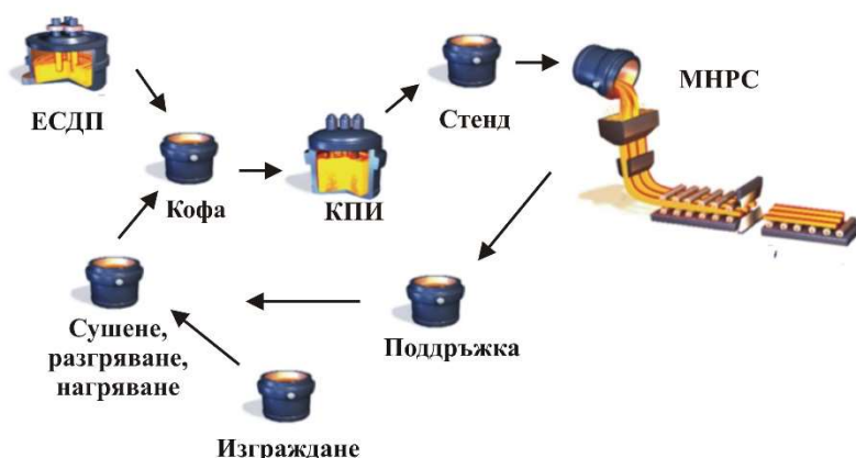
Фигура 1. Схема на работния цикъл на стоманодобивната кофа
